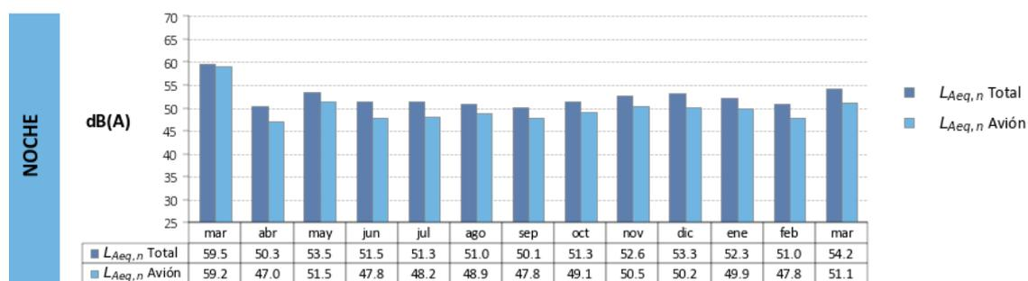
**Aumento de  $L_{Aeq}$  Total y Avión en periodo noche debido al cambio de operativa por la activación del Plan de Contingencia y a un mayor número de operaciones en configuración sur.**
